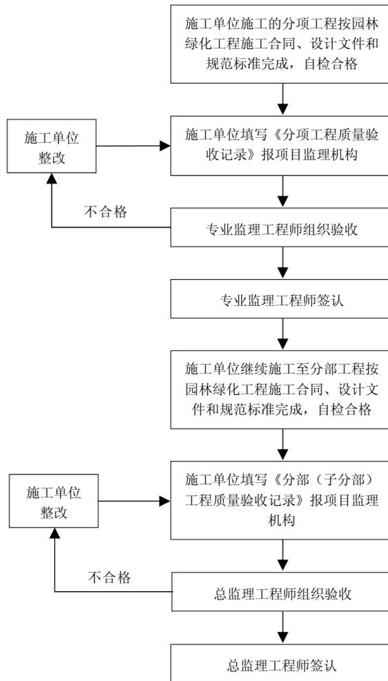
图A.3 分项、分部（子分部）工程验收流程
