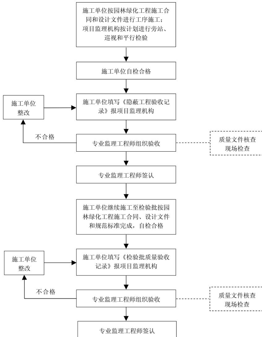
图A.2 隐蔽工程、检验批验收流程
