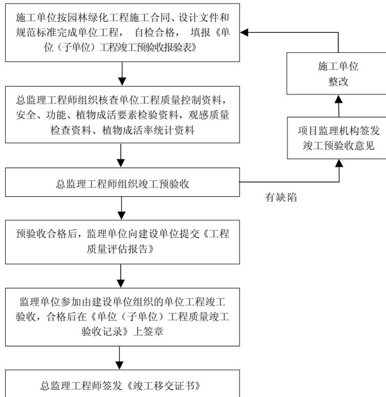
图A.4 单位（子单位）工程验收流程
